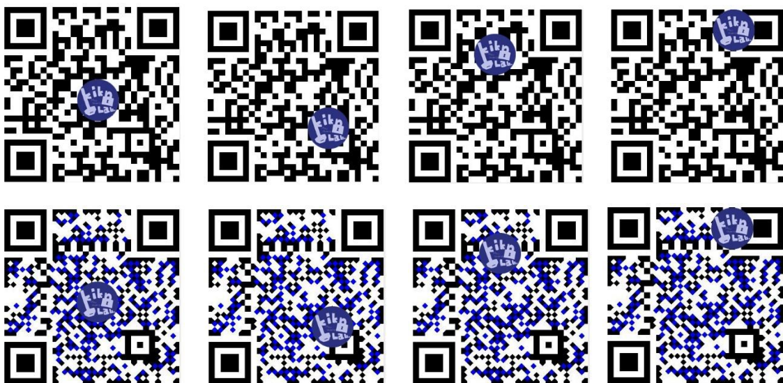
図 7.3: 誤り耐性実験の例(マーク直径 7 セル)
