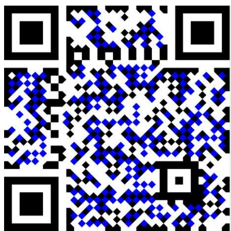
図 4.3: 菱形サブセルを用いる 3-L 型QRコード
