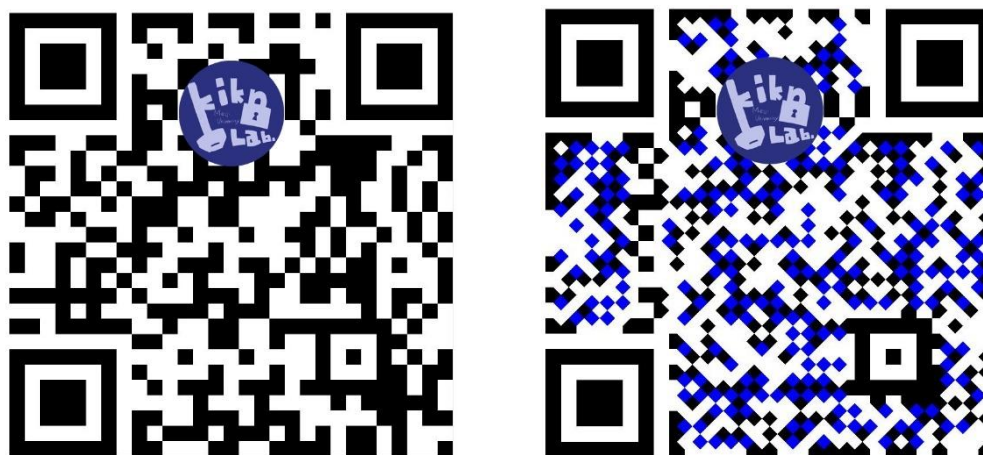
図 7.4: 識別失敗したQRコード (マーク直径7セル)
