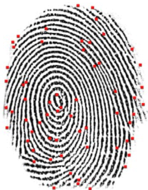
図19 赤点を付けるマニューシャ (2012年12月研究室で測定, mindct を用いた)
